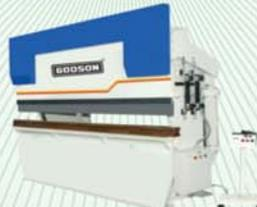
HYDRAULIC / MECHANICAL PRESS BRAKE
